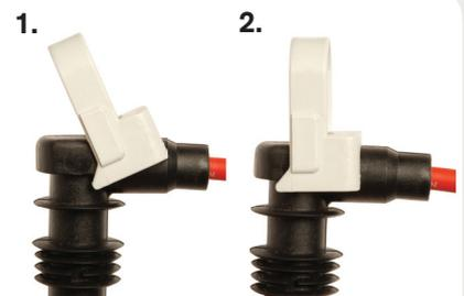
Para sacar o cabo do primeiro cilindro, o sacador deve ser encaixado ao contrário dos demais conforme seqüência 1 e 2 acima.
