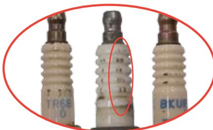
**Obs.: Se ocorrer o Flash Over é necessário a substituição simultânea das velas e cabos.**
