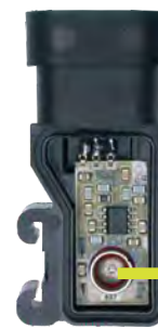
Elemento piezo resistivo
